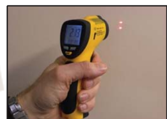
Distance de mesure &lt; distance focale
