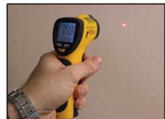
Distance de mesure = distance focale
