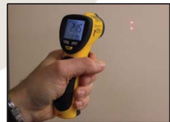
Distance de mesure &gt; distance focale
